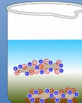
凝集した汚染物質は疎水性が高く、容易に汚濁物質と水を分離する。
